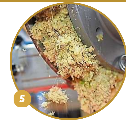
Ein bläulich schimmernder Ring ist das Merkmal der Sorte Uganda Blue Ginger (1). Bei der Ginger Juice Company wird der Ingwer zunächst gewaschen und gebürstet (2 und 3) und anschließend per Fließband (4) zur Vakuum-Schneckenpresse transportiert. Dort wird der Ingwer gemahlen, gepresst und die Rückstände wie die Schale aussortiert (5). Nach der Zugabe von Zitronensäure und Acerola kann der Ingwersaft mit Wasser verdünnt und schließlich eingeschenkt werden (6).
