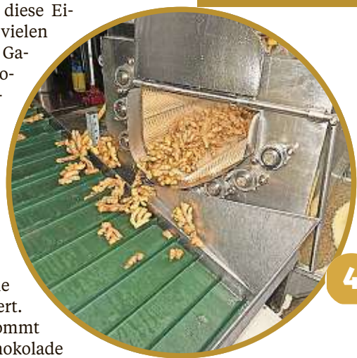
Ein bläulich schimmernder Ring ist das Merkmal der Sorte Uganda Blue Ginger (1). Bei der Ginger Juice Company wird der Ingwer zunächst gewaschen und gebürstet (2 und 3) und anschließend per Fließband (4) zur Vakuum-Schneckenpresse transportiert. Dort wird der Ingwer gemahlen, gepresst und die Rückstände wie die Schale aussortiert (5). Nach der Zugabe von Zitronensäure und Acerola kann der Ingwersaft mit Wasser verdünnt und schließlich eingeschenkt werden (6).
